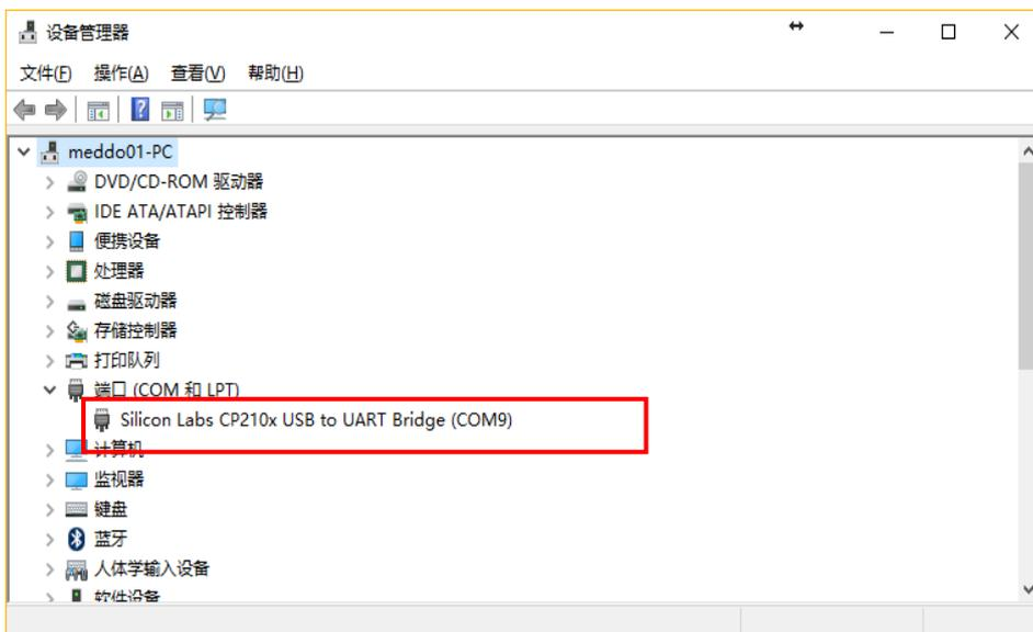
鼠标右键点击 我的电脑—属性，弹出下列对话框。64位操作系统用 CP210xVCPInstaller\_x64.exe
